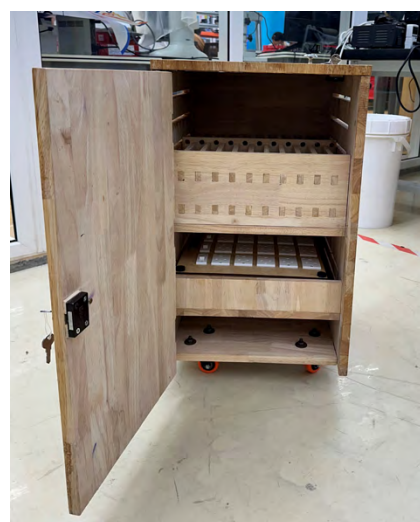
Station de charge mobile entièrement construite d'après le prototype de conception (Bhoutan).
